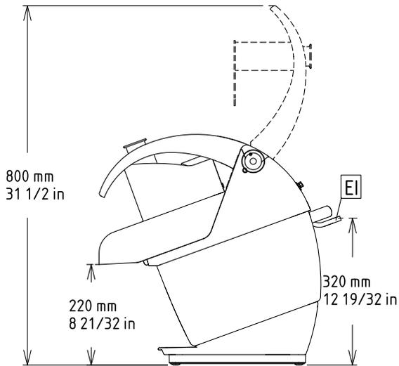
**EI** = Conexión eléctrica (energía)
